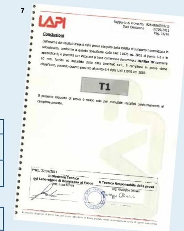
**7. Rapporto di prova ok: l'intonaco, per un determinato spessore, ha ottenuto la classificazione T1 secondo la norma UNI 11076**
