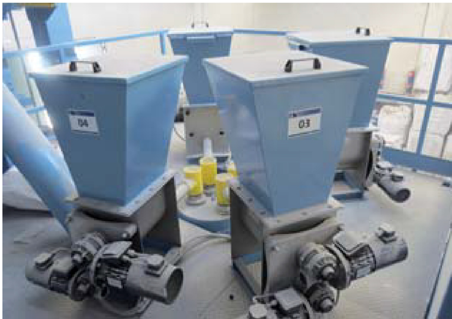
Tramogge per gli additivi
