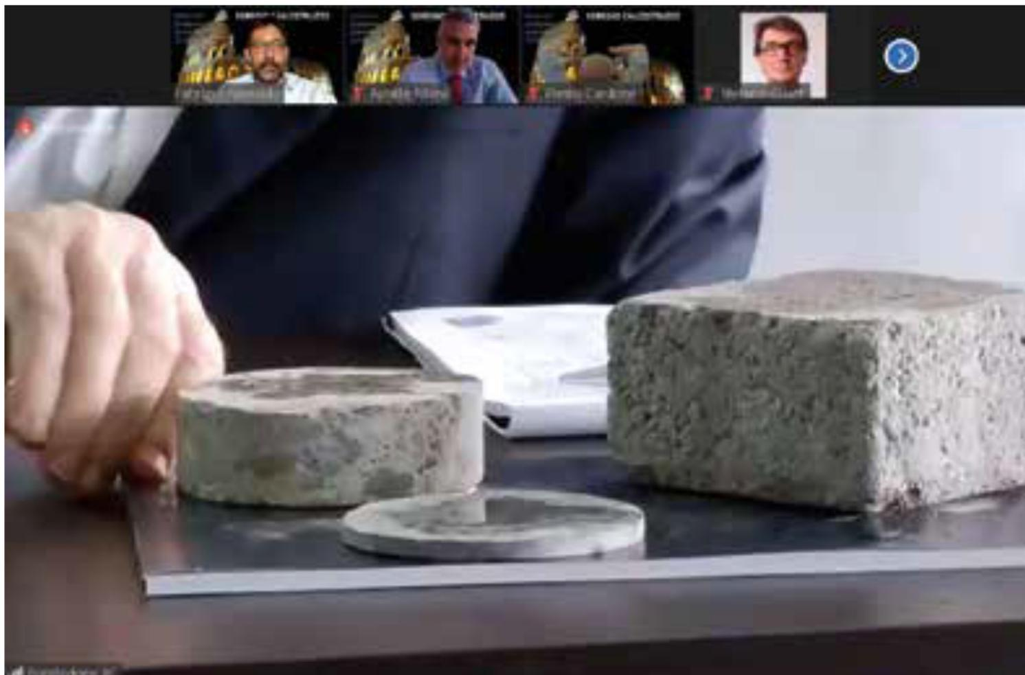
Dimostrazione di penetrazione (o meno) dell'acqua nel corso del webinar: l'acqua non percola nel provino realizzato con Aeternum CAL
